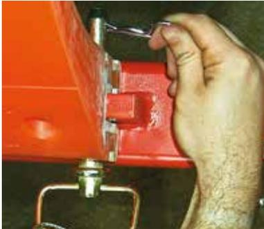
1 Splint vom Bolzen entfernen.
